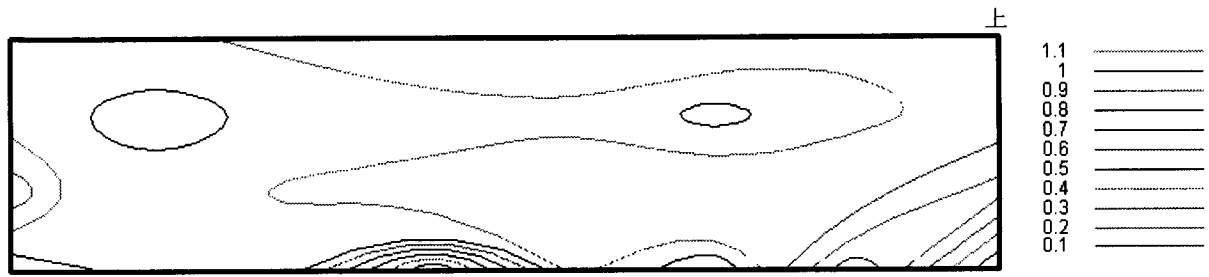
図 4.8 5 段積み 5 列、最上段、最後列、前面の風圧力分布
