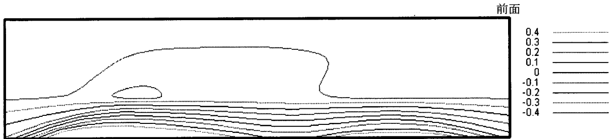
図 4.9 5 段積み 5 列、最上段、最後列、上面の風圧力分布
